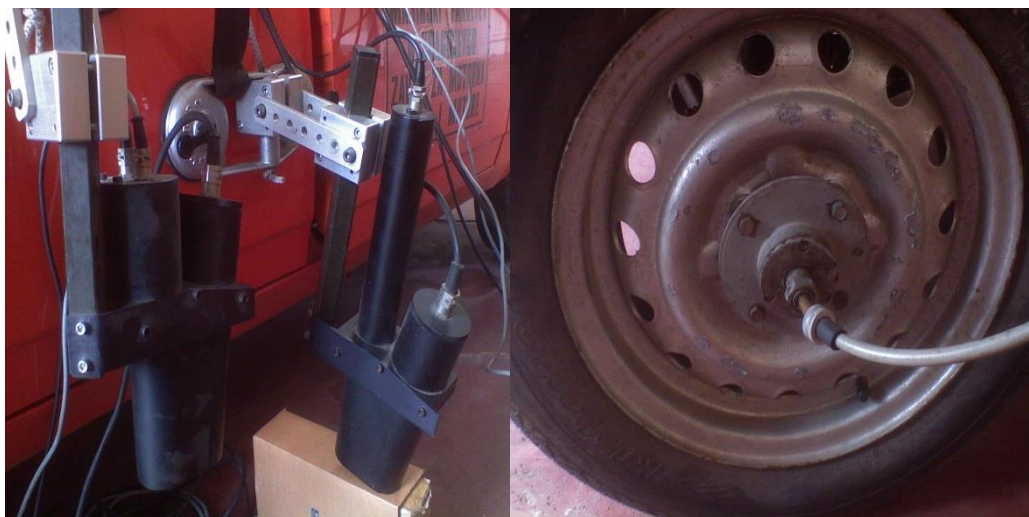
Slika 2. Eksperimentalni sistem za merenje komponenta bazine kretanja vozila. Leitz Correvit MFK/FIN, Kragujevac
