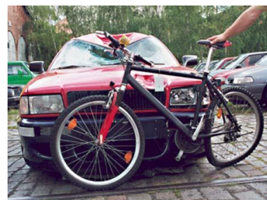
IZGLED I POLOŽAJ OŠTEĆENJA PTOIZVEDENIH NA AUTOMOBILU OD SUDARA SA BICIKLISTOM KOJI JE UDAREN U DESNI BOK PRI ČEONIMDELOM AUTOMOBILA
