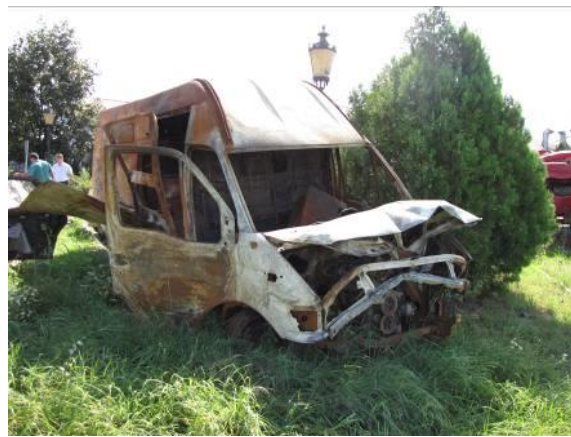
Vozilo oštećeno u požaru
