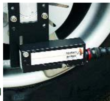
Slika 2. Eksperimentalni sistem za merenje komponenta bazine kretanja vozila. Leitz Correvit MFK/FIN, Kragujevac
