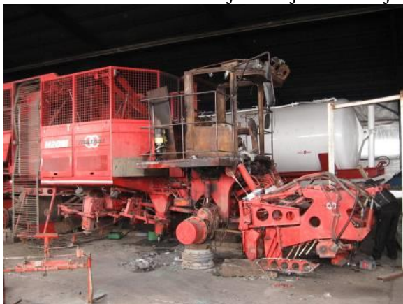
Kabina koja je zahvaćena požarom
